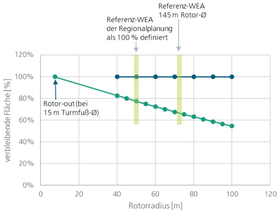
Abbildung 10: Effekt von Rotor-in (grün) auf die effektiv bebaubare Fläche in Abhängigkeit vom Rotordurchmesser im Vergleich zu Rotor-out (blau).
