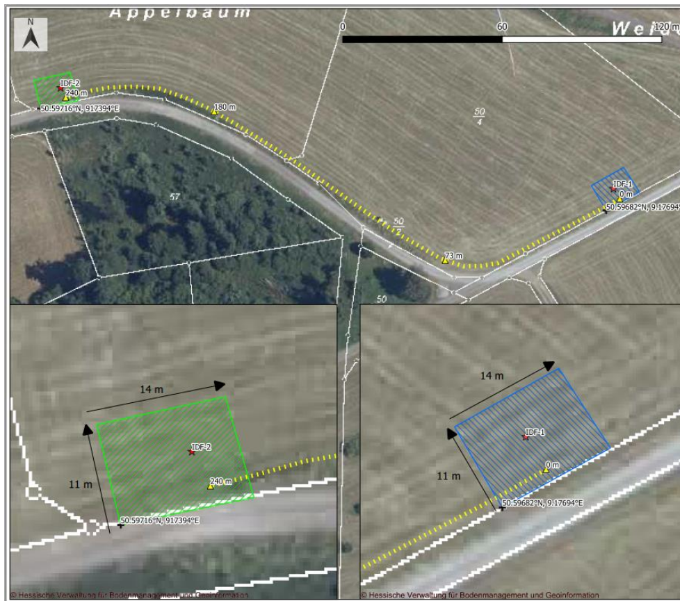
Abbildung 5: Skizze der benötigten Flächen und Kabelverlegung für IDF (jeweils ca. 154 m 2 )
